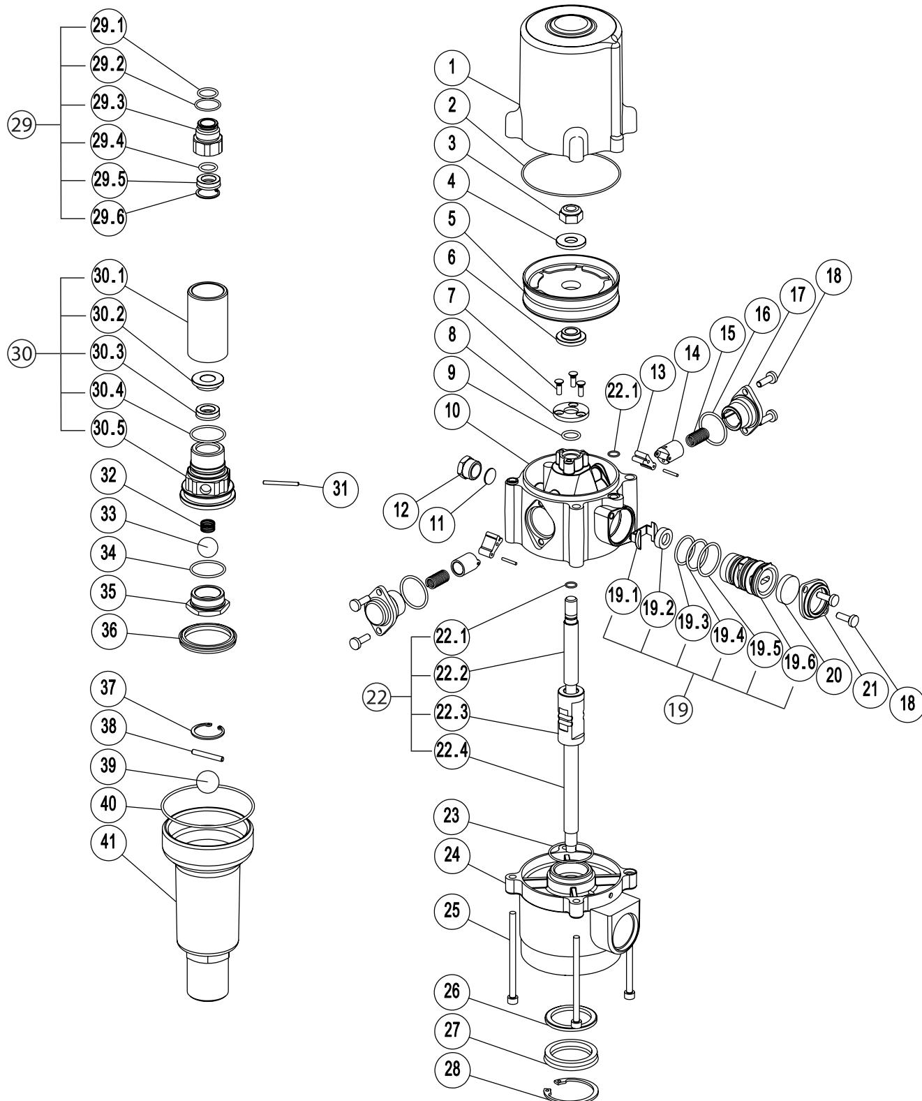
Рис. 11-1: Составные части пневматического насоса для масла
